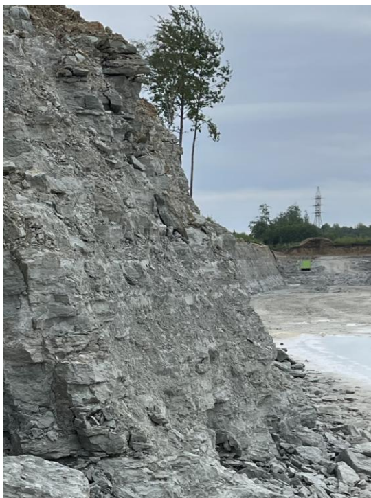
Joonis 1 – Hüdrovasaraga kaevandatud nõlv
